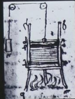
da Vinci Dampfkolben
