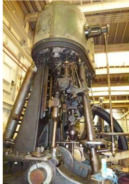
Heutiges Aussehen der Dreifachexpansionsmaschine im Dampfzentrum Winterthur.
