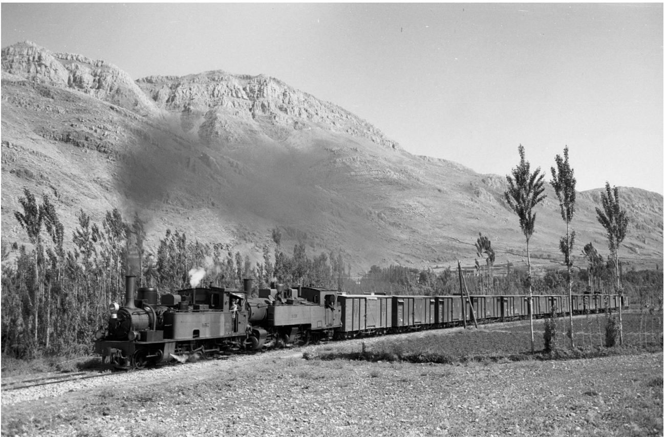
Auf der Libanonbahn von Beirut nach Damaskus leistet die 1893 in Winterthur erbaute 130-755 Vorspann vor der Mallet 2+21-962, erbaut von Hartmann in Chemnitz. Die Spurweite beträgt 1050 mm. Bei Al Zabadani in Syrien, 5. Juni 1966.
