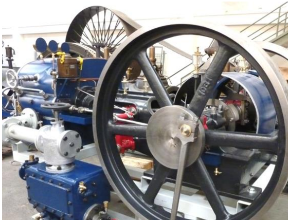
2-Zylinder-Labordampfmaschine, Assmann + Stockder Stuttgart 1920, aus dem Technikum Biel.
