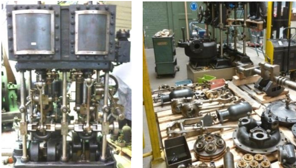
2-Zylinder-Schiffsdampfmaschine, Escher Wyss Zürich 1910, DS „Lützelau“. Leihgabe Technorama.
