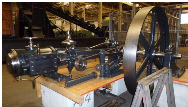
Die 1-Zylinder-Dampfmaschine von 1891 aus dem Hause Sulzer ist eine typische KMU-Maschine.
