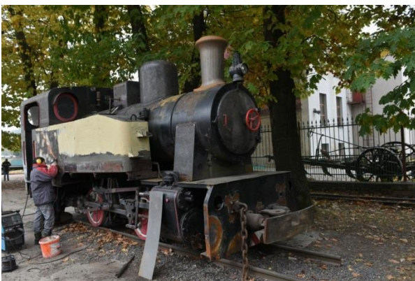
Revisionsarbeiten unter freiem Himmel. Die kleine Brn2t fährt auf der Kindereisenbahn von Kosice
