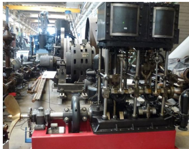
Schiffdampfmaschine Lützelau Sockelmontage, Anbau eines Propellers und eines Elektromotors
