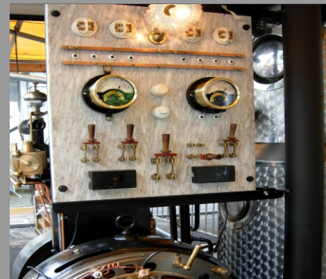
1-Zylinder-Dampfdynamo King, Wollishofen, Alioth, Münchenstein 1884 Dampfschiff «Beatus», Thunersee
